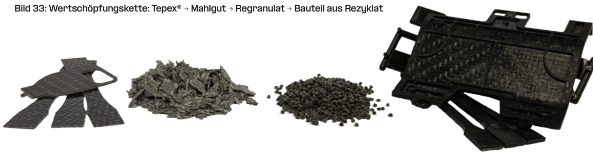
Bild 33: Wertschöpfungskette: Tepex® → Mahlgut → Regranulat → Bauteil aus Rezyklat
